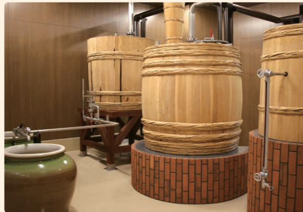
木樽蒸留器 日本唯一の職人「津留安郎」氏作製の木樽蒸留器です
