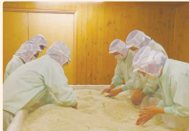
麹室 厳重な温度管理のもと麹菌を繁殖させ、麴米をつくっています
