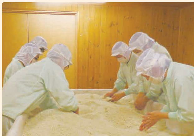
麹室 厳重な温度管理のもと麹菌を繁殖させ、麹米をつくっています
